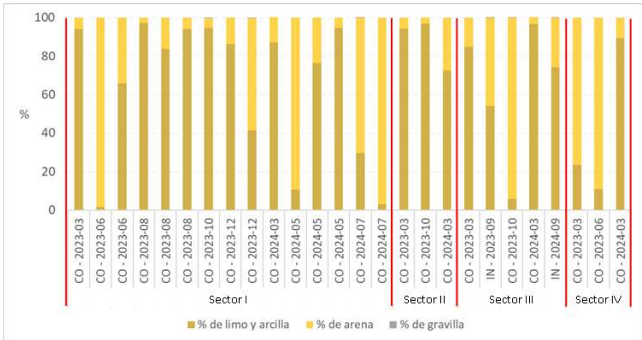
Figura 3-2: Granulometría de sedimentos en cada sector de intervención del canal de acceso, entre Mar/2023-Sep/2024 (Elaborado a partir de datos de INVEMAR (IN) y Cormagdalena (CO)).
