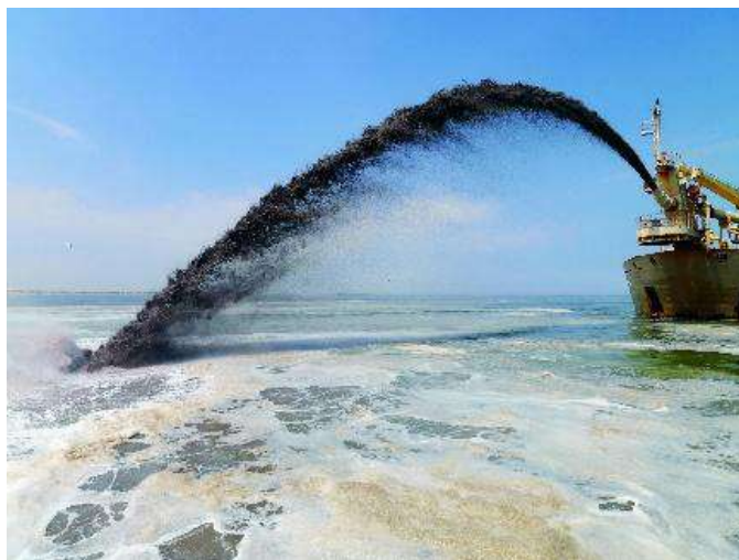
Figura 2-3: Metodología típica para esparcir materiales dragados en el mar. Fuente: Departamento holandés de Vías Navegables y Obras Públicas.
